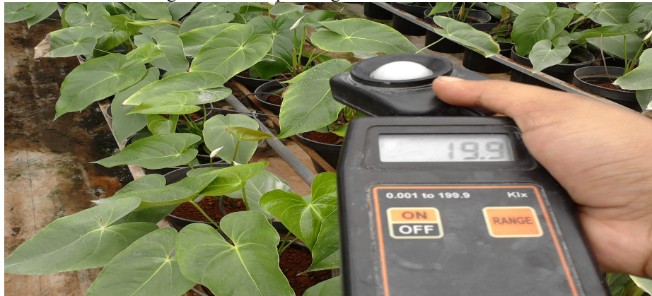
Figura 53.- 20 \text{KLux} ( 370 \mu\text{molm}^{-2}\text{s}^{-1} ) máximo dentro del invernadero de anthurio protegido con mallas sombra y pintura vinílica blanca en la cubierta plástica.
