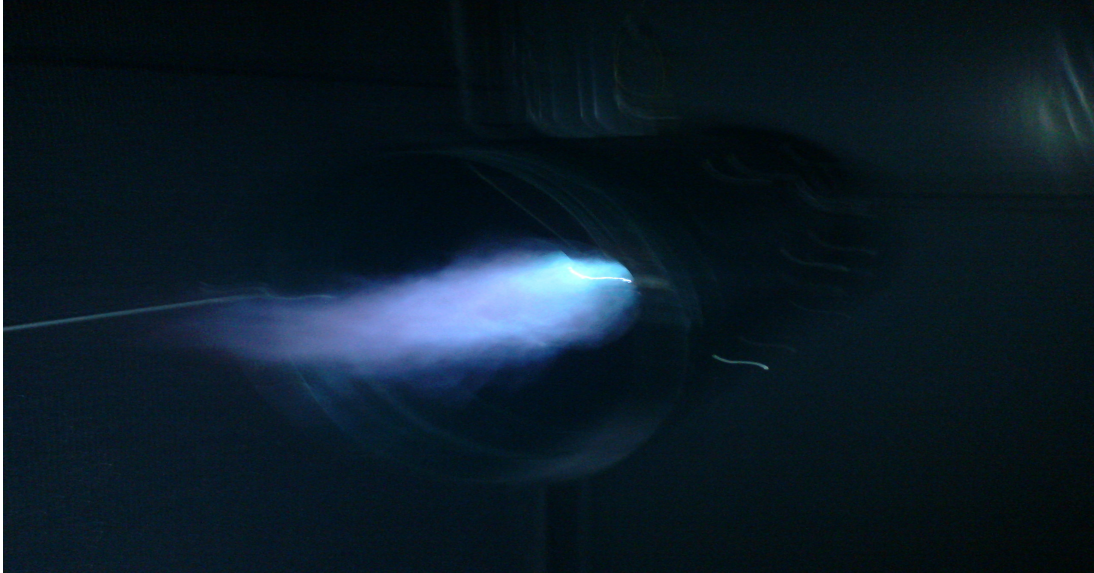
Figura 68.- Centinela trabajando con una quema de gas eficiente mostrándose con una Llama de color azul (3.50am).
